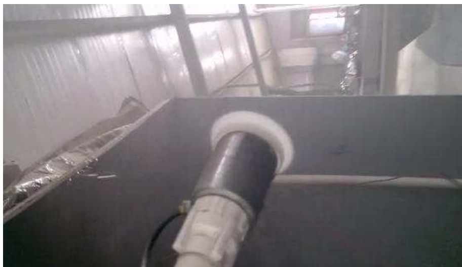
↑ドライミストモーターによるミスト噴霧実験の様子
